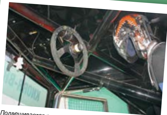
Подвешивается рулевое колесо (поставщик — компания OMP) сверху на каркасе безопасности. Там же, под потолком подвешивается и шлем. Предстартовый алгоритм таков: пилот садится в кресло, пристегивается четырехточечным ремнем, фиксирует рулевое колесо и надевает шлем
