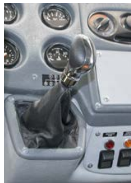
Рычаг коробки передач сделан в виде джойстика и размещен на приборной панели
