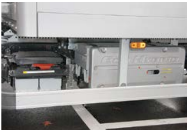
Блок аккумуляторов крепится на раме за кабиной и открыт всем дорожным неприятностям, но съедает много грузоподъемности
