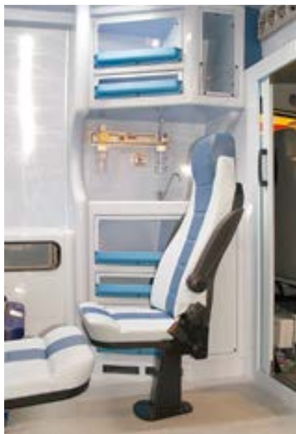
Формованные панели без острых углов, из которых изготовлены полки и шкафы, — залог полной травмобезопасности медперсонала
