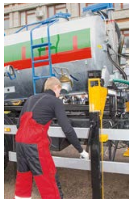
Легкосъемные опорные ножки с винтовыми домкратами усилием в 5 кг
