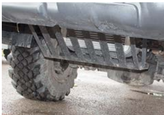
Радиатор снизу прикрыт мощной защитой
