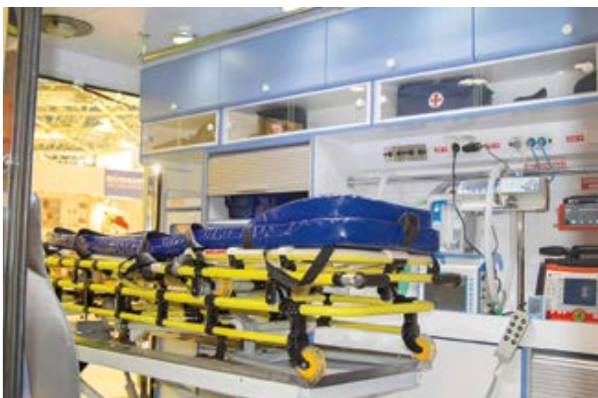
Так, например, благодаря оригинальному кузову появилась возможность разместить под потолком целый ряд шкафчиков для хранения медицинских принадлежностей
