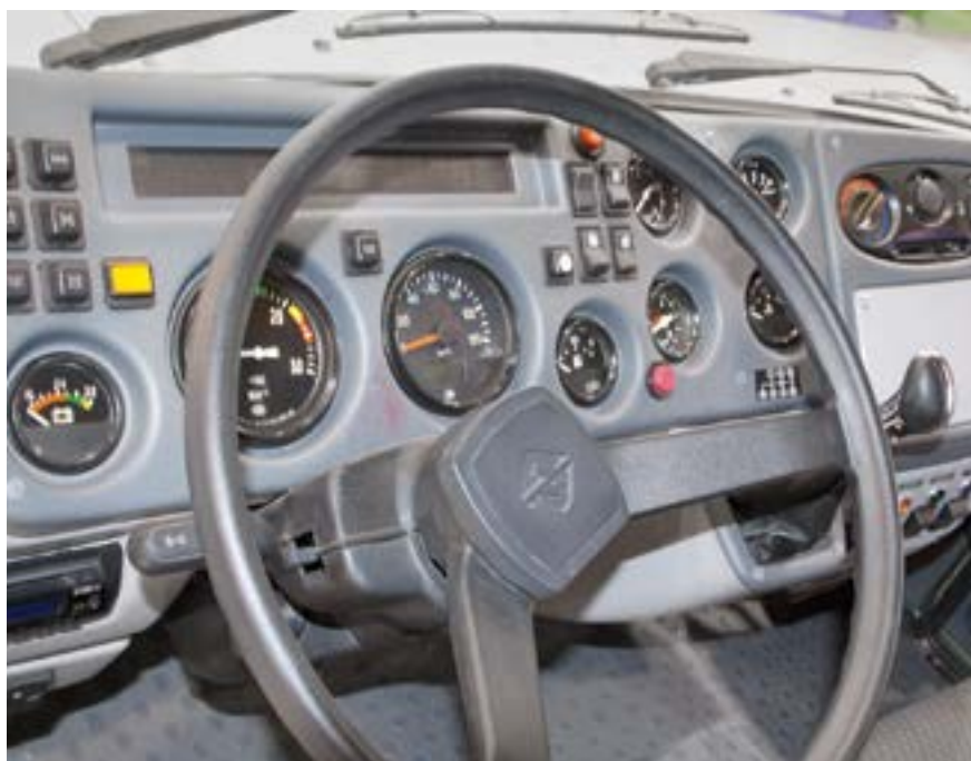
Управление раздаточной коробкой и включение механизмов межколесных блокировок производится кнопками
