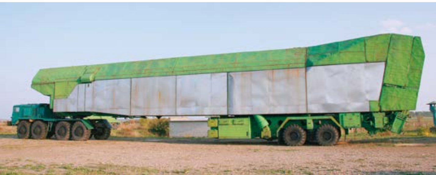
Установщик УТПК-2 для ракеты SS-24 Scalpel торцом к торцу стыковался с монстроподобным транспортировщиком. Ракета передвигалась в его «телегу», затем установщик задом подъезжал к шахте, кузов поднимался и ракета опускалась в стакан «спецсооружения»
