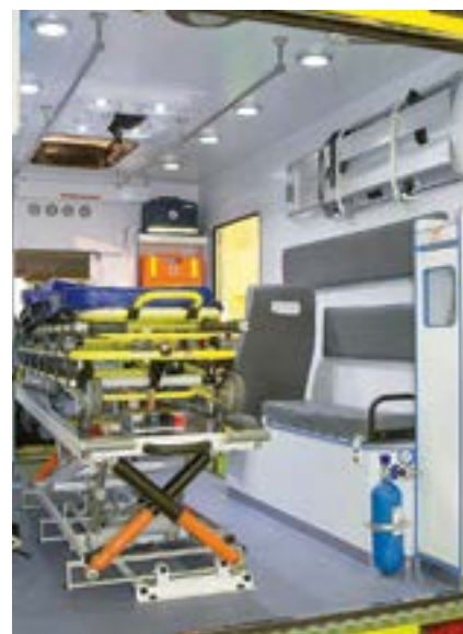
При перемещении приемного устройства в сторону рундука можно спокойно обойти вокруг транспортных носилок
