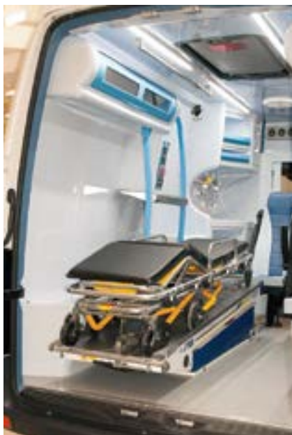
Гидропневматическая подвеска поддерживающего устройства для носилок итальянской фирмы Stem предотвращает укачивание при транспортировке
