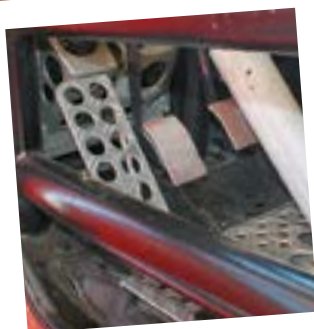
Педальный узел. Обратите внимание на обилие отверстий в площадках. В гоночном грузовике абсолютно все подчинено снижению веса
