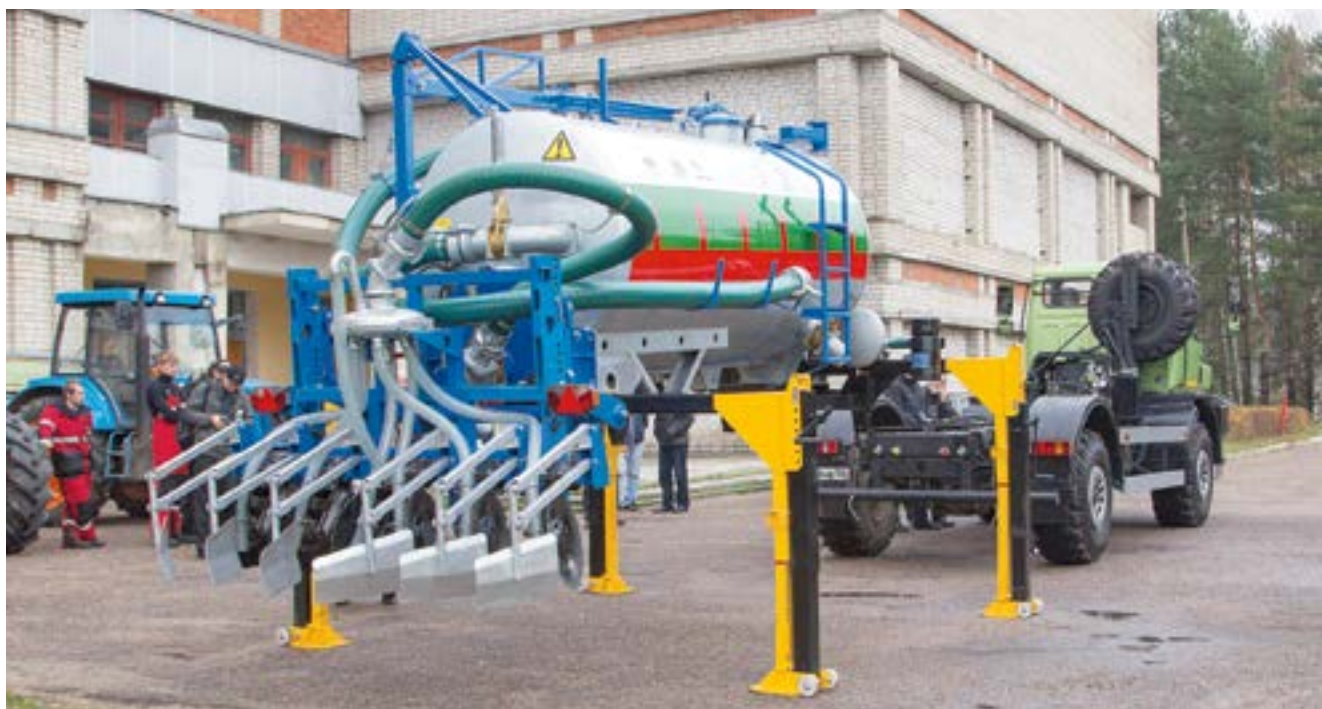
Кузов «на ножках» гораздо меньше подвержен опасности коррозии при стоянке на грунте
