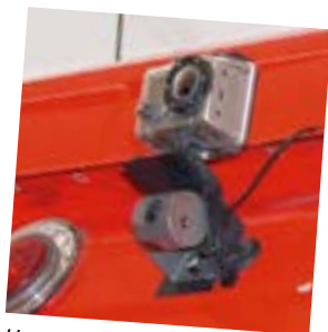
Наверху за кабиной установлена камера GoPro. В современном трак-рейсинге для мониторинга ситуации на трассе зеркал заднего вида уже не достаточно
