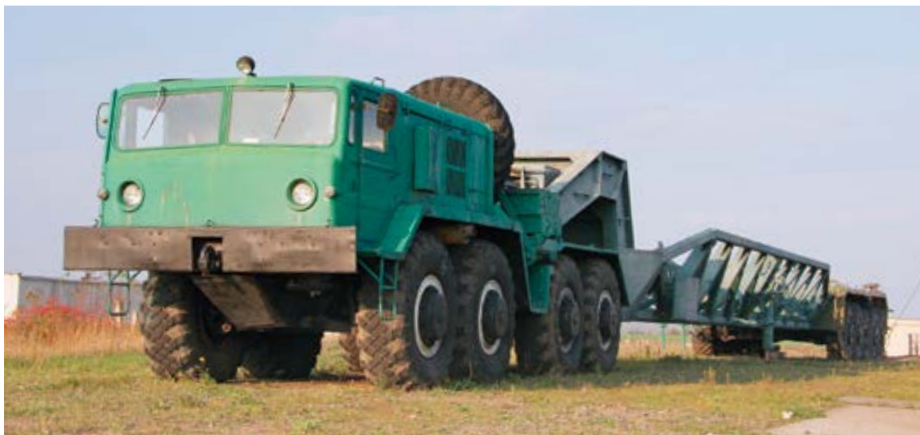
«Изделие 15Т145М» — транспортный агрегат для транспортно-пускового контейнера ракет семейства «Сатана» и контейнера командного пункта — автопоезд в составе седельного тягача МАЗ-537Е и пятиосного полуприцепа со всеми поворотными колесами. Полная масса — 125 т. Длина — больше 40 м!
