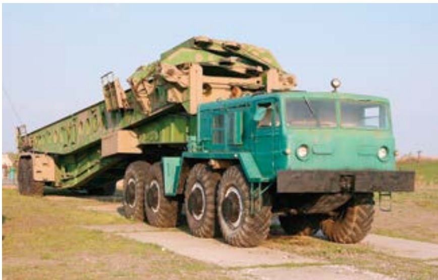
«Изделие 15У164» — установщик контейнера командного пункта. Также это 70-тонное устройство устанавливало в шахты и ракеты «Сатана»
