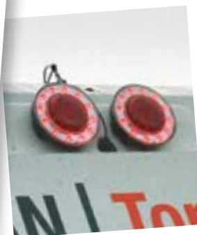
Контактная борьба — норма в трак-рейсинге. Поэтому задние фонари, зажигающиеся при снижении скорости, многие команды размещают в верхней части задней стенки кабины. Предпочтение отдают, конечно, особо яркой диодной оптике. Так поступил и Йохан Хан
