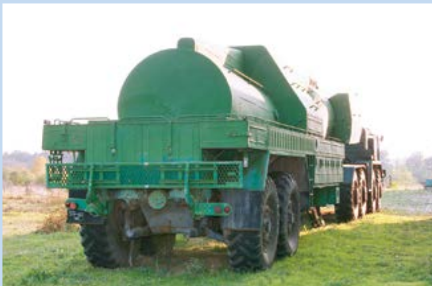
ЗАЦ-1 (Изделие 15Г95) — агрегат транспортировщик-заправщик окислителя перевозил 39 т амил
