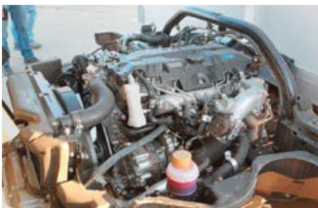
Главная новинка на российском рынке — 4,9-литровый турбодизель. Он выдает 180 л.с. и 530 Нм, причем 2/3 мощности доступны уже с 1000 об/мин
