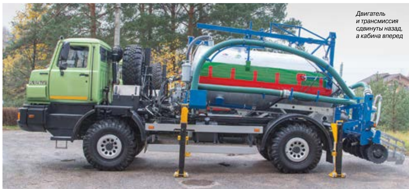
Легкосъемные опорные ножки с винтовыми домкратами усилием в 5 кг
