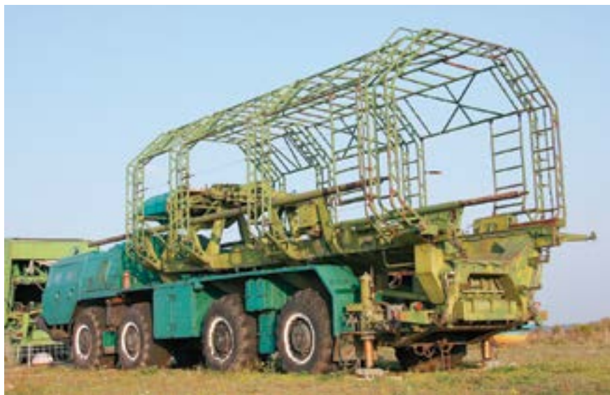
Транспортно-установочный агрегат надставки для ракеты 15А35 (SS-19 Stiletto) на шасси МАЗ-543А — одна из спецмашин для перевозки и установки одной из «запчастей» одного из типов ракет
