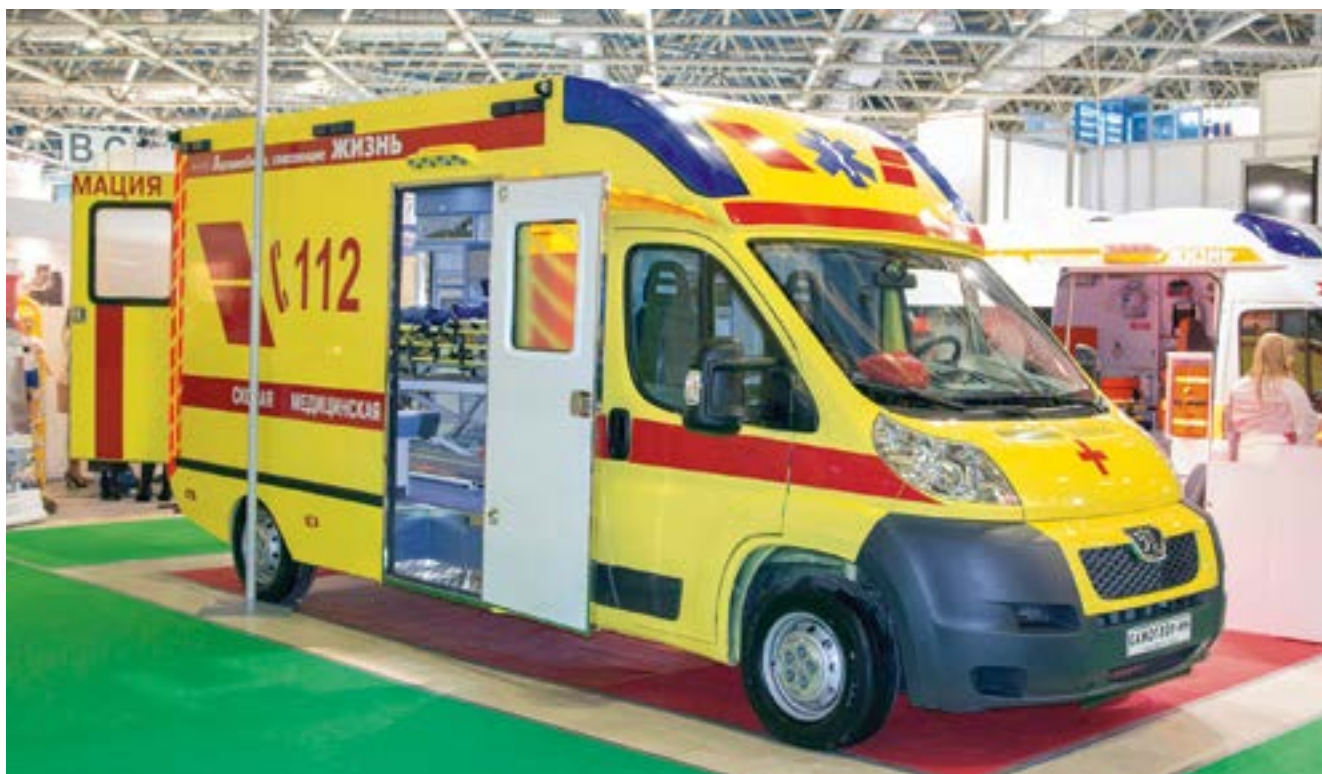
Оригинальный кузов, установленный на шасси Peugeot Boxer, значительно расширяет пространство для работы медиков
