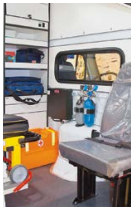
Салон внутри разделен перегородкой со сдвижным окном на два отделения: водительское и медицинское
