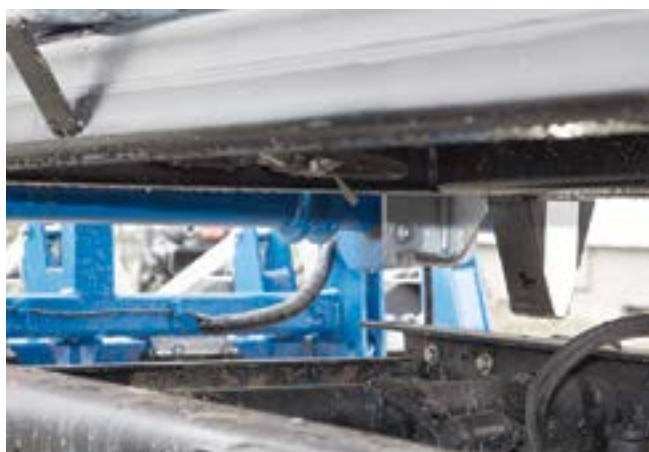
Упор-фиксатор надрамника к раме
