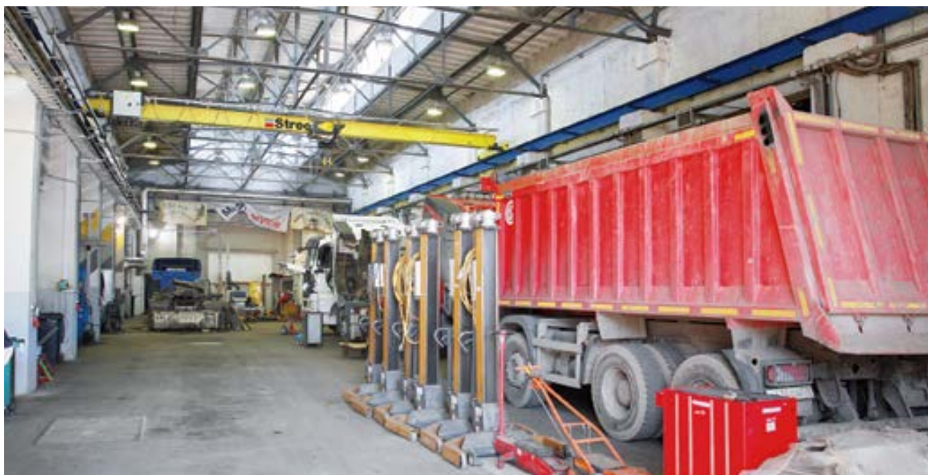
Подъемные колонны справятся даже с тяжелым самосвалом
