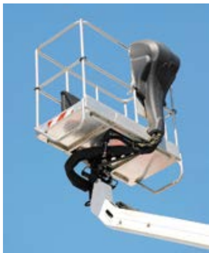
Современная алюминиевая люлька оборудована пультом и может дополнительно поворачиваться влево-вправо
