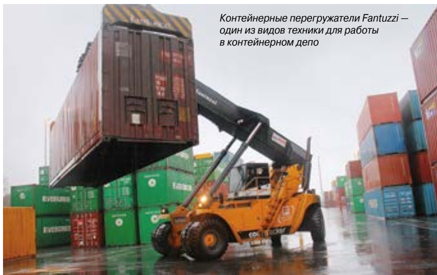
Контейнерный перегружатель со специальным оборудованием для перегрузки генеральных грузов
