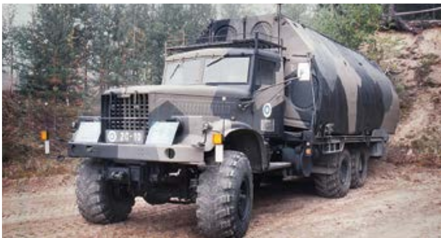
Речное звено понтонно-мостового парка ПМП Вооруженных сил Финляндии
