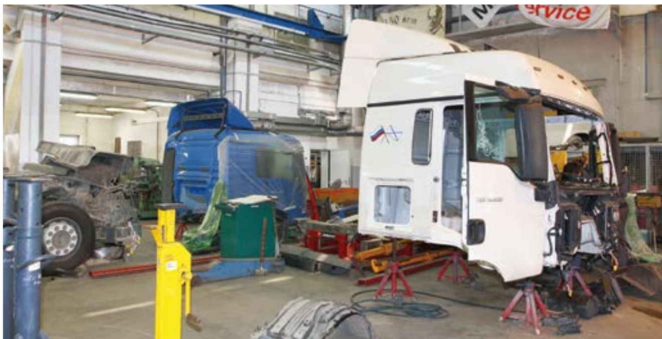
Оборудование позволяет восстановить геометрию кабины даже после аварии
