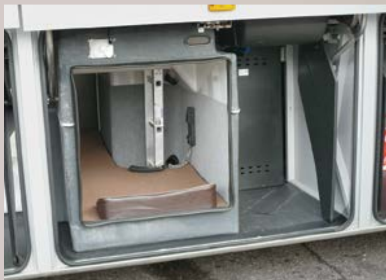
В водительских спальниках устанавливают освещение и климатическую установку
