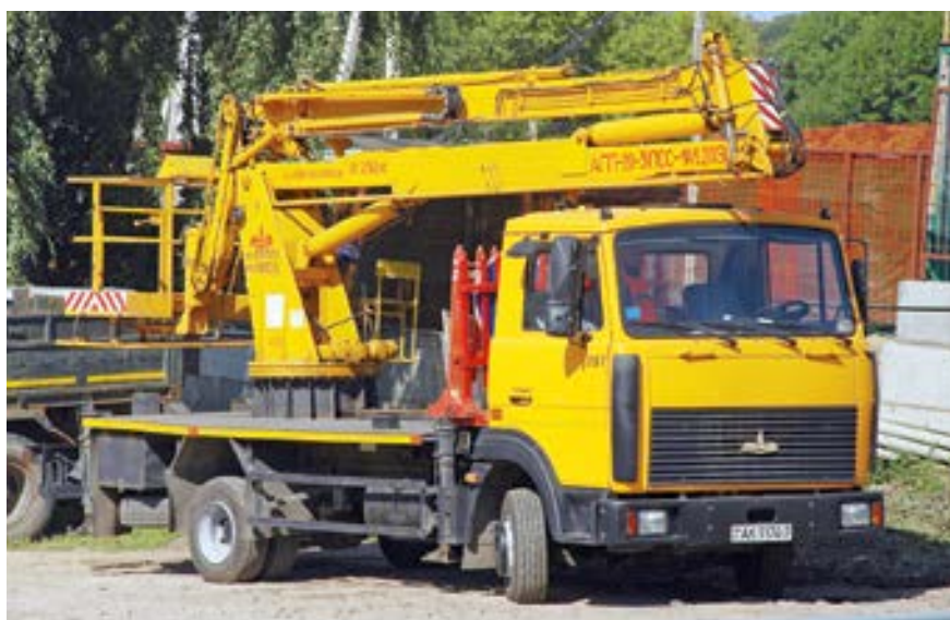
Дважды комбинированный АГП-20-3 из Могилева: коленчато-телескопическая стрела и гидромеханическая система стабилизации люльки
