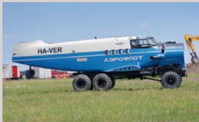
В Венгрии на шасси КрАЗ-255Б установили фюзеляж от «кукурузника» Ан-2. Результатом стал эффектный шоу-стоппер для различных технических фестивалей
