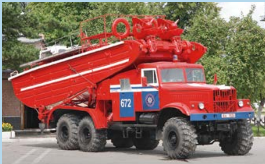
Пожарный автомобиль ПАК-40 (255Б) 16650ПМ — это катер БМК-Т и его транспортер, переоборудованные на Торжокском ПО «Противопожарная техника»
