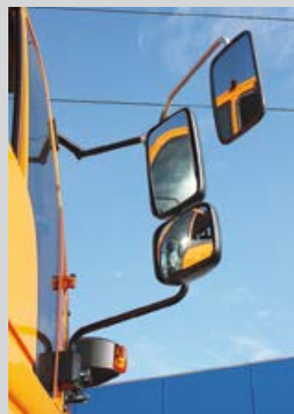
Для работы на железной дороге необходима специальная расширенная система зеркал заднего вида
