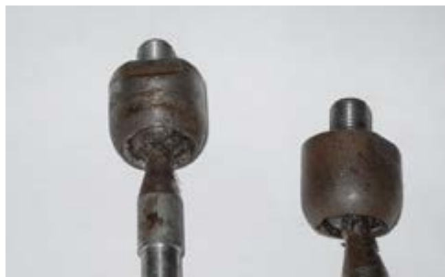
Основная причина появления люфтов в рулевых тягах — износ шаровых шарнирных соединений
