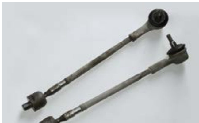
Эти рулевые тяги отработали без замечаний 108 000 км, а наконец-таки и вовсе пока «живые». Но, исходя из пробега, было решено попутно их заменить
