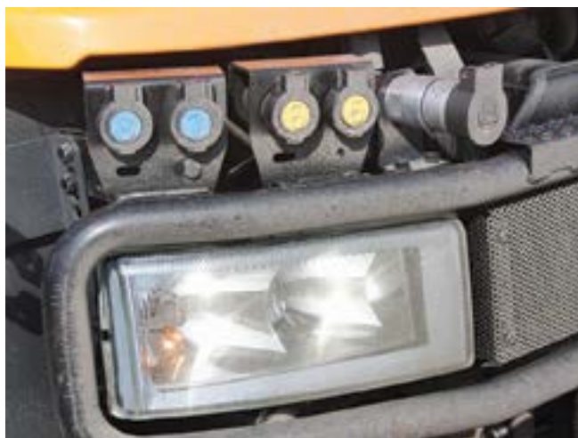
Цветовая и цифровая кодировка гидроразъемов существенно облегчает процесс подключения навесных приспособлений
