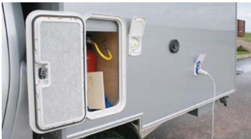
Слева по ходу движения ниша для газового баллона, розетка питания и горловина для заправки чистой водой
