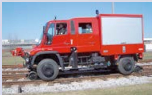
На железнодорожных противопожарных и аварийно-спасательных работах «Унимого» на комбинированном ходу тоже применяются. Вторую кабину боевого расчета изготавливает не Daimler, а специализированные фирмы
