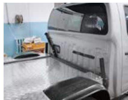
Трак-кемпер оборудуется универсальной платформой для установки кузова и жилого модуля
