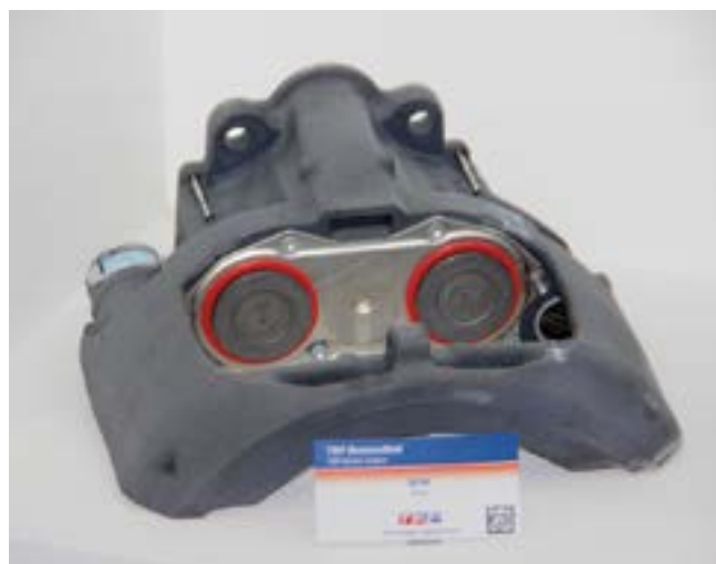
Современные дисковые тормозные механизмы надежны и герметичны. Ремонтные воздействия подразумевают только замену и смазку крепежа и пыльников, ну и колодок, конечно. Замена манжет и поршней, как правило, безрезультативна
