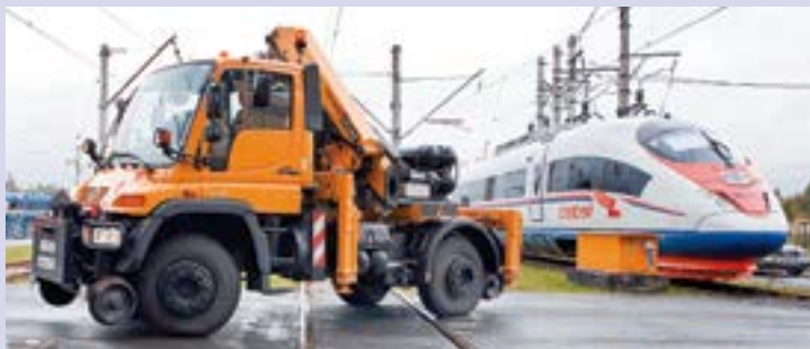
Такой длиннобазный локомотив Unimog U400 с КМУ Palfinger работает в Санкт-Петербурге в моторвагонном депо «Московское», обслуживающем «Сапсаны»
