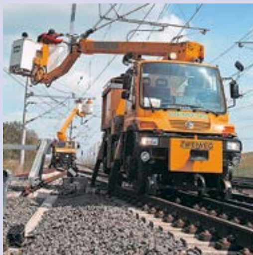
С уверенностью можно сказать, что коленчатый подъемник — второй по популярности тип надстройки для ж/д-«Унимогов» после КМУ
