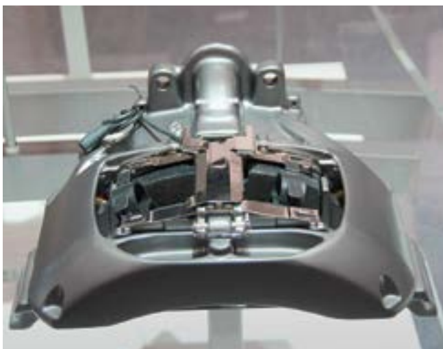
Современные дисковые тормозные механизмы надежны и герметичны. Ремонтные воздействия подразумевают только замену и смазку крепежа и пыльников, ну и колодок, конечно. Замена манжет и поршней, как правило, безрезультативна
