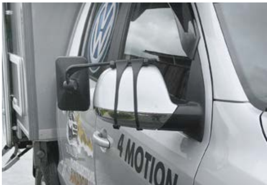
Для лучшего обзора зеркала вынесены при помощи дополнительных кронштейнов
