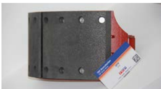
Переклейка тормозных накладок барабанного механизма для современных моделей — пустая трата времени и материалов
