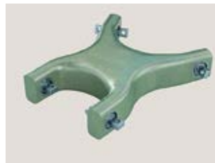
ZF представляет прототип четырехточечного рычага из композитного материала на стекло-волокнутой основе. По сравнению с литым рычагом, он легче на 25%, что означает снижение веса примерно на 11 кг
