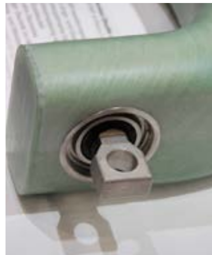
Заменить рычаг в сборе или сайлент-блок? Вопрос, достойный обсуждения!
