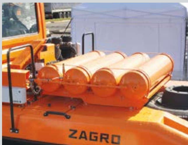
Ресиверы тормозной пневматической системы для буксируемых вагонов. Между ними и кабиной установлен компрессор
