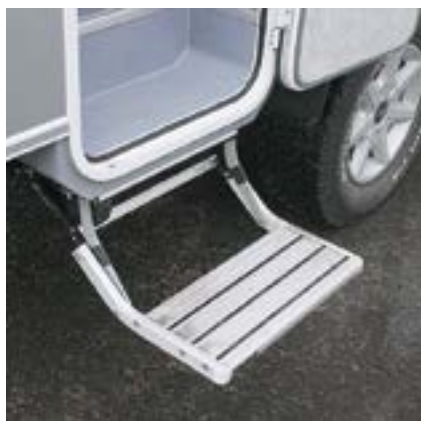
Ступенька входа выдвигается автоматически
