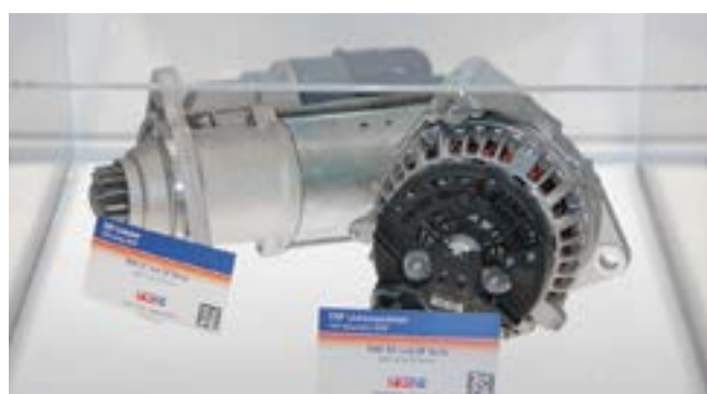
Ремонт стартеров и генераторов вместо их замены на новые экономически целесообразен, но ресурс этих восстановленных узлов значительно ниже новых
