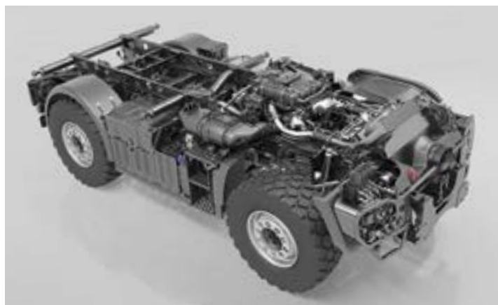
Агрегаты ходовой части Unimog, и так скомпонованные плотно, грядущие нормы Euro-6 еще больше уплотнят. На снимке как раз шасси следующего поколения. Новый Unimog будет представлен в 2014 г.
