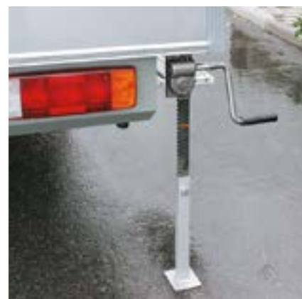
Автономный модуль можно установить на четырех «домкратах» без автомобиля
