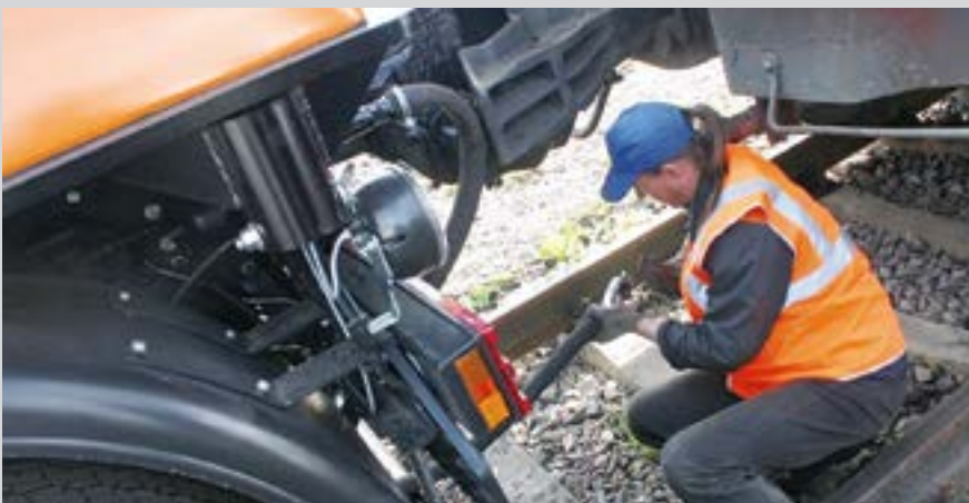
Процесс соединения пневмосистемы локомотива с тормозными пневмомагистралями железнодорожных вагонов
