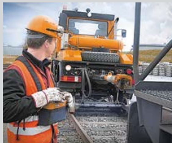
Возможность работы на дистанционном управлении — одно из главных принципиальных отличий от стандартных маневровых локомотивов
