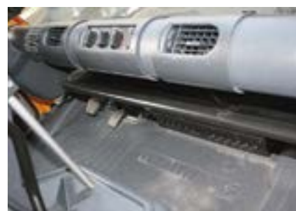
По такой направляющей рулевая колонка может быть передвинута с левой на правую сторону
