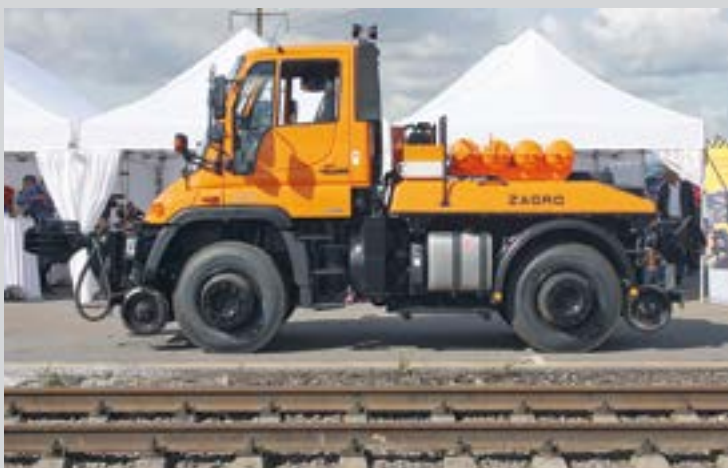
В транспортном режиме рельсовые направляющие поднимаются вверх. Оборудование для постановки на железнодорожный ход изготовлено компанией ZAGRO Bahn- und Baumaschinen GmbH
