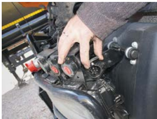
Рядом с гидравлическими есть и электрический разъем
