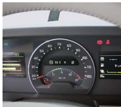
На щитке приборов только один циферблат. Привычная стрелка сменилась бегунком, который перемещается вдоль шкалы спидометра. Остальные данные выводятся на два экрана. Компоновка совершенно новая, очень удобная. Привыкаешь к ней моментально!
