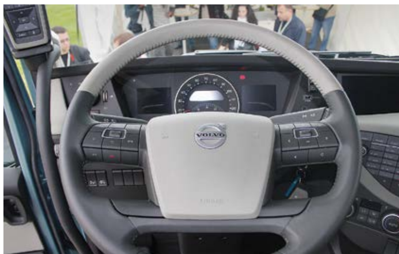
На рулевом колесе разместили девятнадцать клавиш и придали ему великолепный диапазон регулировок
