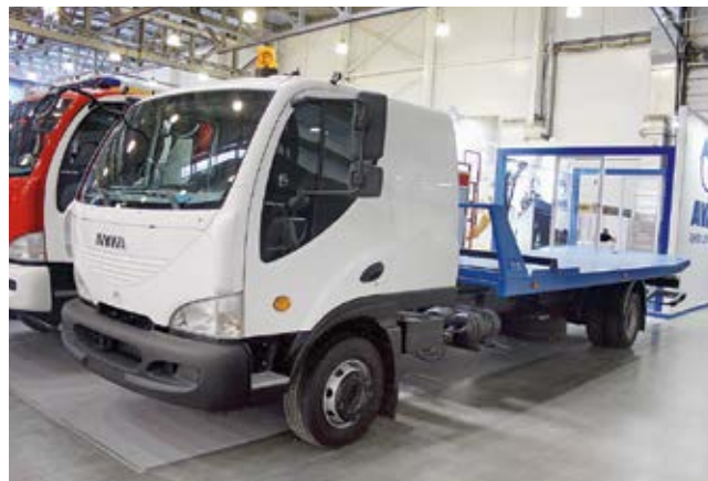
Длиннобазное шасси Avia D120 со спальным кабиной и эвакуаторной платформой «Смартэко»
