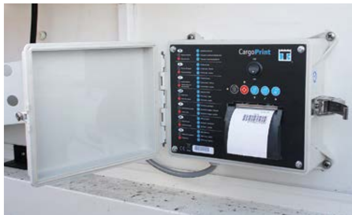
Регистратор температурных режимов. Устройство, по смыслу напоминающее тахограф, только для транспортного холодильника. На снимке блок CargoPrint от ThermoKing
