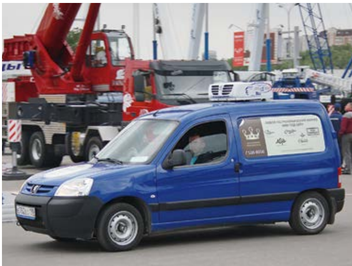
Бюджетный способ превратить «каблук» в рефрижератор. На крыше Peugeot Partner смонтирована итальянская малогабаритная холодильная установка Zanotti
