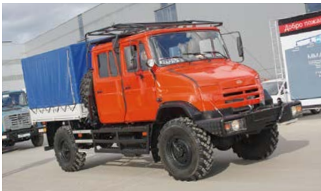
Пожарный лесопатрульный комплекс МЛПК на полноприводном шасси ЗИЛ-4327
