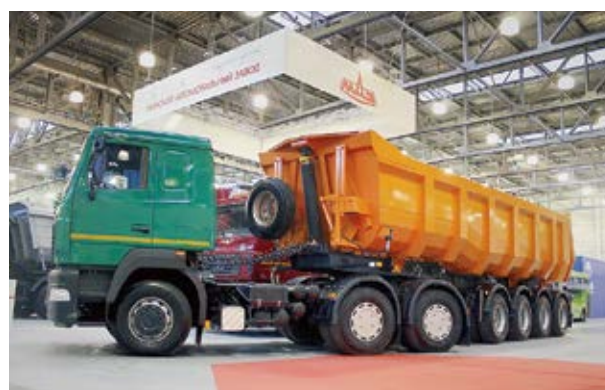
Самосвальный автопоезд, состоящий из тягача МАЗ-6430W8 и четырехосного полуприцепа МАЗ-954700
