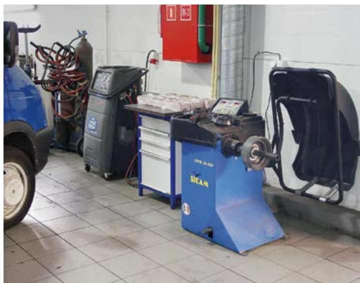
В одном блоке размещен станок балансировки колес и аппарат заправки кондиционера
