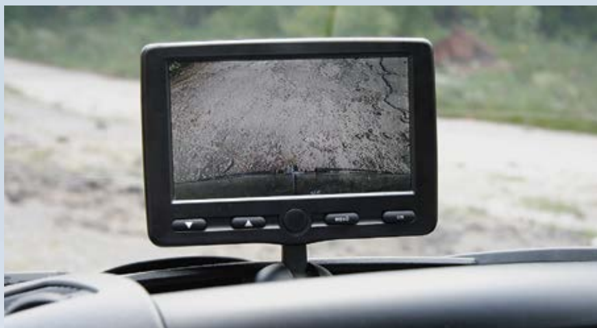
Камера заднего вида помогает при парковке, изображение выводится на складной дисплей в центре приборной панели
