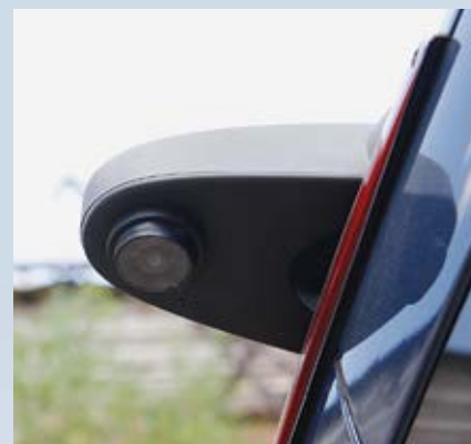
Камера заднего вида помогает при парковке, изображение выводится на складной дисплей в центре приборной панели
