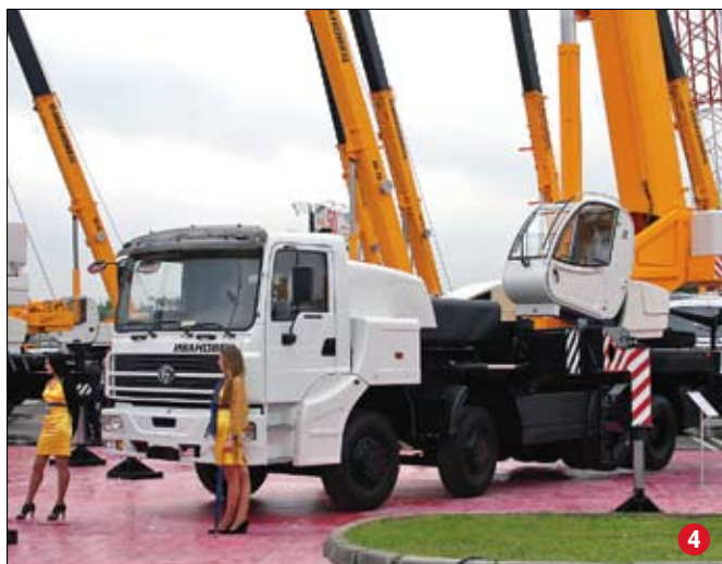
5. 50-тонный кран «Галичанин» КС-65713-6.
