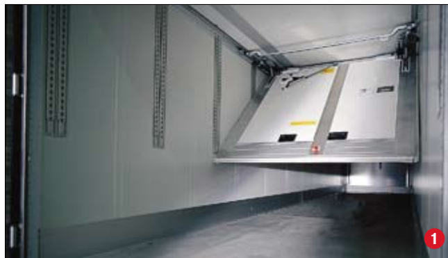
1. Промежуточная стенка позволяет поддерживать два разных температурных режима в одном фургоне. 2. Еще одно ноу-хау – двухъярусная загрузка.
